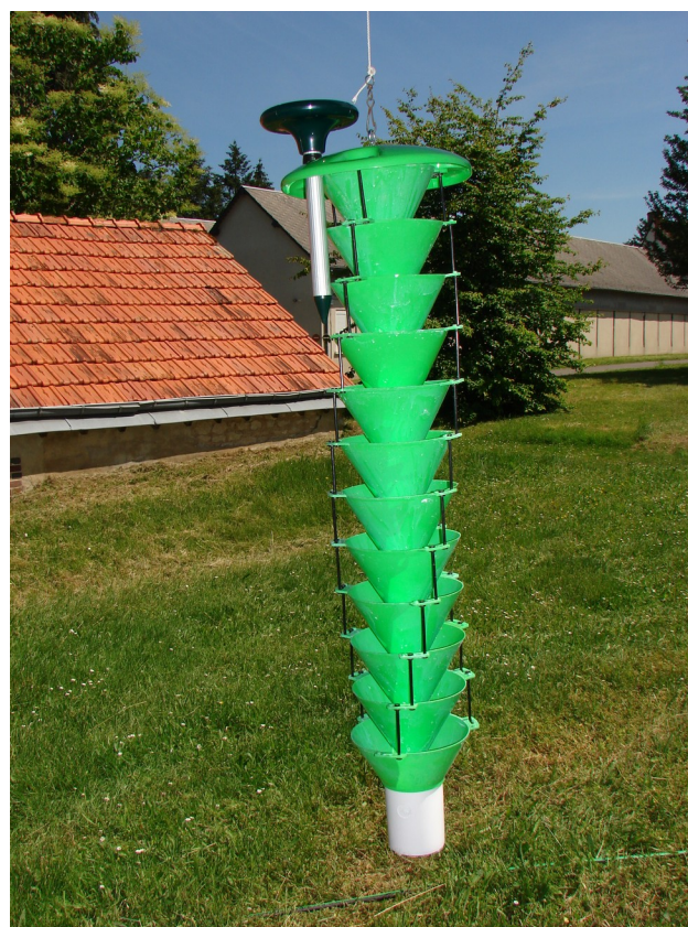
Figure 5: Lindgren avec dispositif de répulsion à ultrasons
